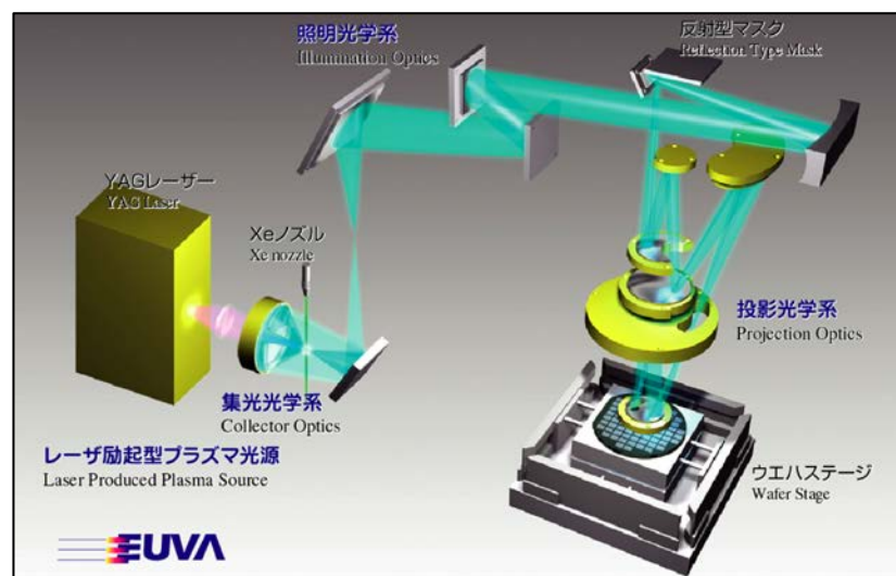
(図) EUV リソグラフィ露光機概念図(EUVA の資料による)
